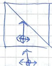
Ein Teil des o-Strahls wird im  $15^\circ$  zum Lot reflektiert. Ebenso ein Teil des o.o. Strahls.
