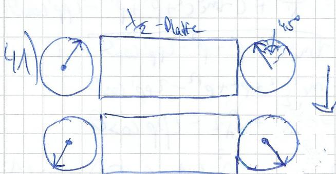
Spiegel und Phasenversetzung um  $\pi$  (durch) Parallel-als auch SenkrechtKomponente
