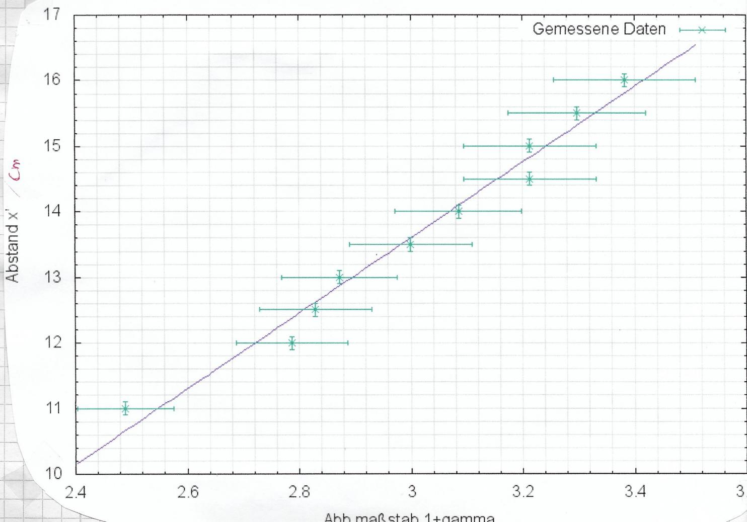
b) Unser Bezugspunkt  $P_{Bz}$  war genau bei 45 cm gewählt, wobei er durch den Mittelpunkt zwischen den beiden Linsen markiert wurde. Damit müssen in unserer Skizze die experimentell bestimmten Werte für  $h, h'$  und  $f_m$  auch von dort aus abgetragen werden (die Skizze befindet sich weiter vorne, Aufgabe E).
