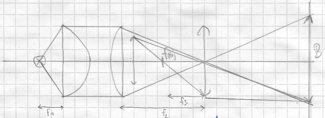
Nachdem man das Gerät auf gleichmäßige Bildfeldausdehnung und die Dias gut eingestellt hat, misst man an 20 Messpunkten die Bildfeldausdehnung. Dann dreht man die Sammellinse des Kondensiers und wiederholt die Messung. Als letztes misst man die Vergrößerung und untersucht Abbildungsfehler des Objektivs.
